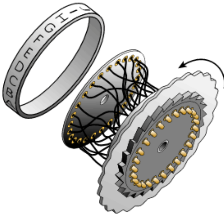
Bilag 8 - en simplificeret tegning af ledningsnettet inden i en rotor - Kilde:
